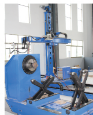
自动焊机 Automatic Welder
